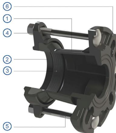
Муфты серии SMART являются стандартизованной продукцией с неизменными размерами и обеспечивают идеальное и быстрое соединение между трубами из любого материала с одинаковыми или различными внешними диаметрами до 327 мм. Фланцевые адаптеры имеют универсальную рассверловку PN 10/16.
