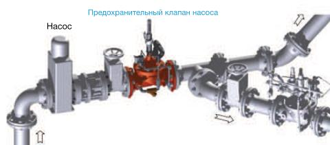
Перед гидравлическими регулирующими клапанами установить сетчатый фильтр, например 90-501
