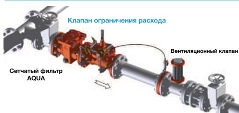
Перед гидравлическими регулирующими клапанами установить сетчатый фильтр, например 90-501, установить сетчатый фильтр, например 90-501.
