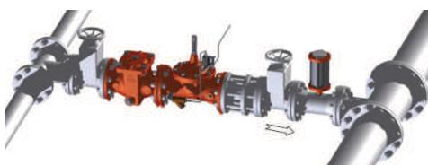
Перед гидравлическими регулирующими клапанами установить сетчатый фильтр, например 90-501.
