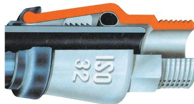
Все ISO фитинги поставляются также в исполнении для PVC труб со специальным зажимом «Корунд» за дополнительную плату!
